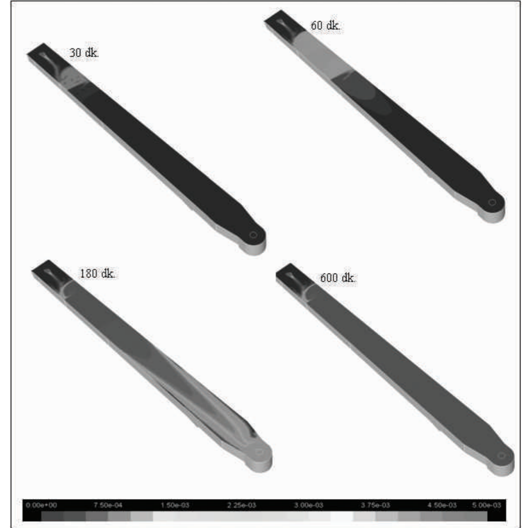
Şekil 7. Forehearth yüzeyinde frit konsantrasyonunun zamana bağlı değişimi
