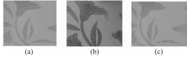
Şekil 6. Altyapımcıda pişirilmiş olan transferin (a) hidrojen sülfür kabinine girmeden önceki resmi, (b) hidrojen sülfür kabinine girdikten sonraki resmi ve (c) CAM’da yeniden pişirilip hidrojen sülfür kabinine girdikten sonraki resmi
